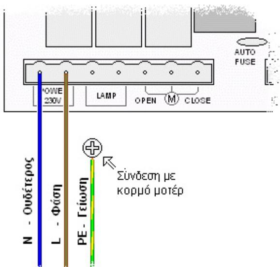
Η σύνδεση με το ρεύμα, γίνεται σύμφωνα με το πλαινό σχήμα.
