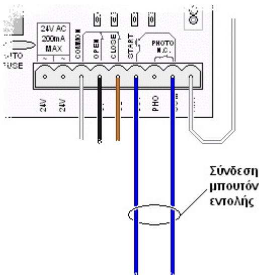
Για να συνδέσουμε μπουτόν εντολής, χρησιμοποιούμε τις επαφές BUT και COM, όπως στο διπλανό σχήμα. Τα μπουτόν χειρισμού είναι ουσιαστικά, διακόπτες NO (Normally-Open ή Κανονικά Ανοιχτοί) με αυτόματη επαναφορά.
